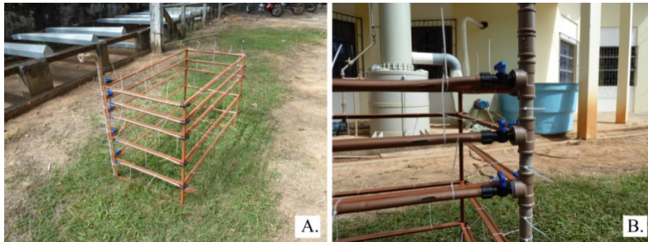
Figura 2. Estrutura metálica utilizada para manter os gotejadores na profundidade de ensaio (A) e detalhe do conector inicial com válvula utilizado para controle das linhas. Metal structure used to maintain the assay's depth of the emitter (A) and detail of the initial connector valve used to control the drip lines (B)
