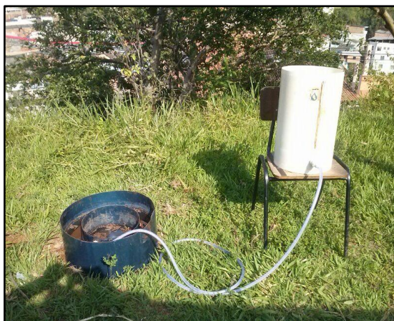
Figura 2 – equipamento convencional modificado para teste de infiltração.
