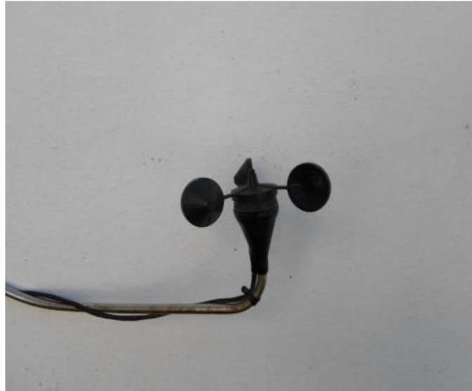
Figura 5. Anemômetro de conchas utilizado para medição da velocidade do vento Fonte: Feitosa, 2014.
