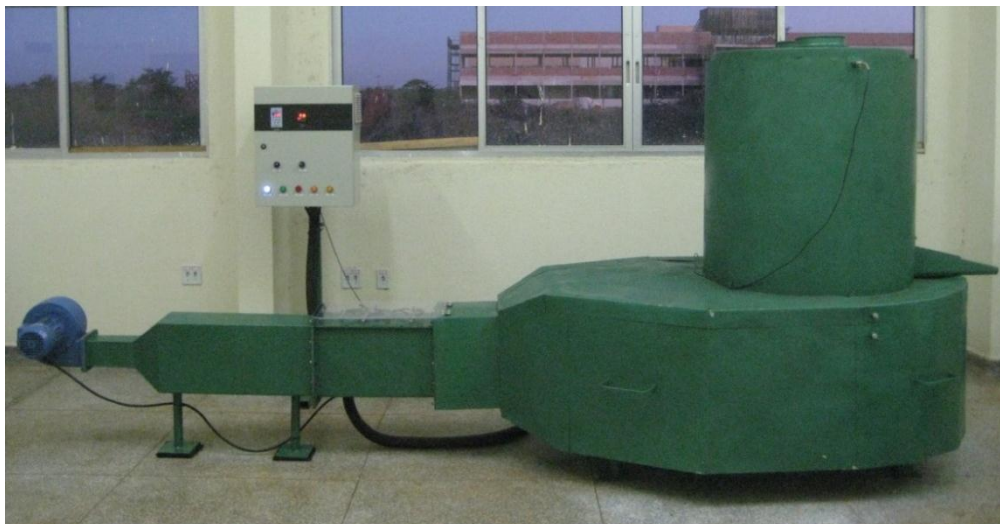
Figura 2. Secador experimental para secagem em camada delgada e espessa de produtos agrícolas.
