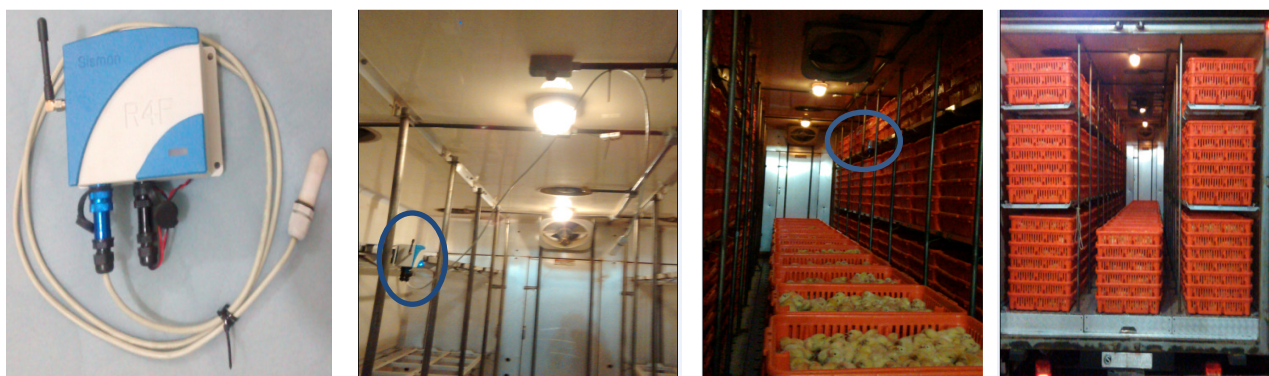
Figura 1. Imagens do sistema Control-AVE e instalação no contêiner do caminhão de pintos.
