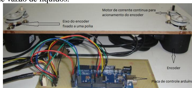
Figura 1: Bancada de ensaio para testes com placa de controle arduino, encoder e sensor de vazão de líquidos simulando rodados motrizes em tratores agrícolas.
