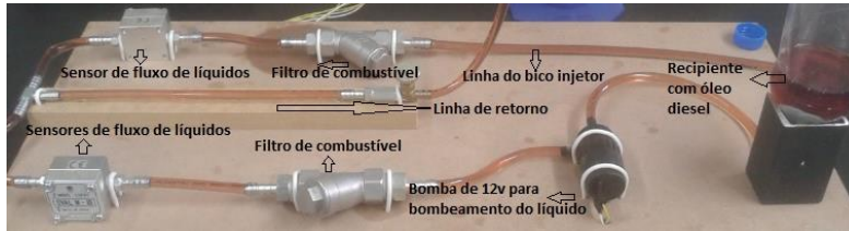
Figura 2: Bancada de ensaio para testes com placa de controle arduino e sensores de vazão de líquidos simulando adaptação dos sensores em motor diesel em tratores agrícolas.
