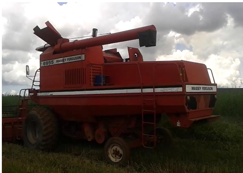
FIGURA 1. Colhedora tangencial Massey Ferguson 6855, na colheita de arroz de terras altas.
