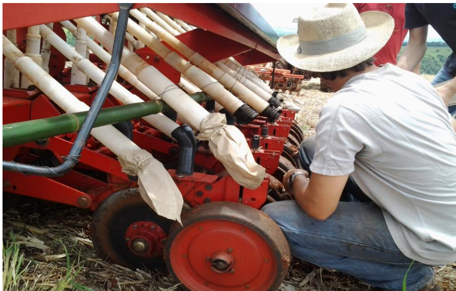
Figura 1: sacos de papel kraft fixados nos tubos condutores
