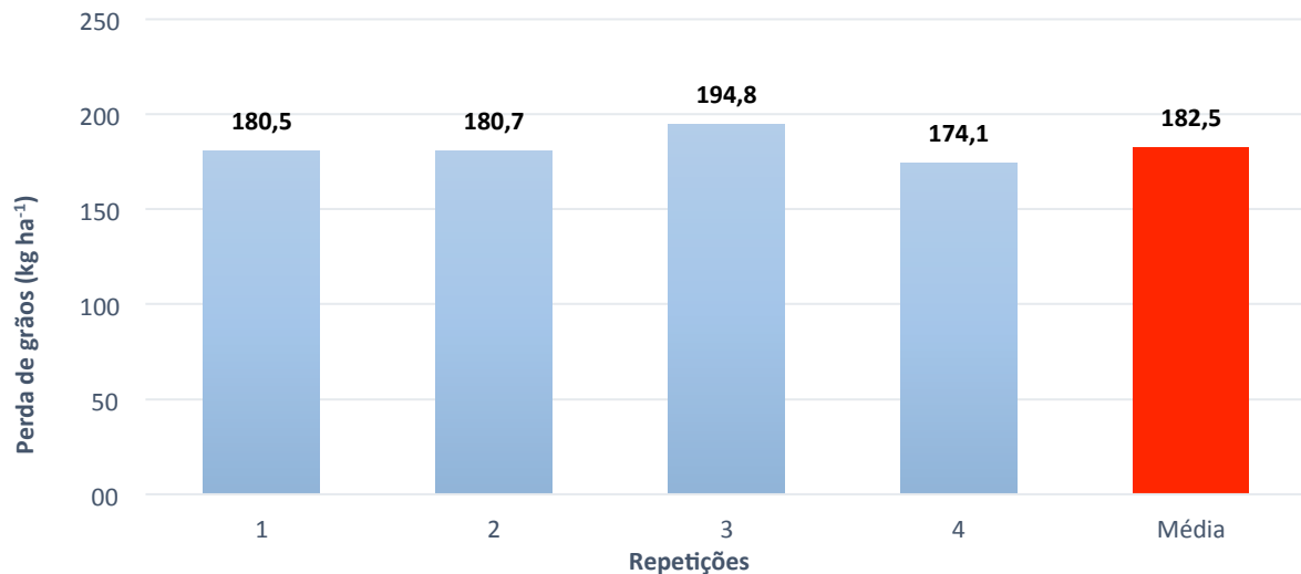
FIGURA 2. Perdas na colheita da soja com plataforma convencional, por repetição de amostragem e média.
