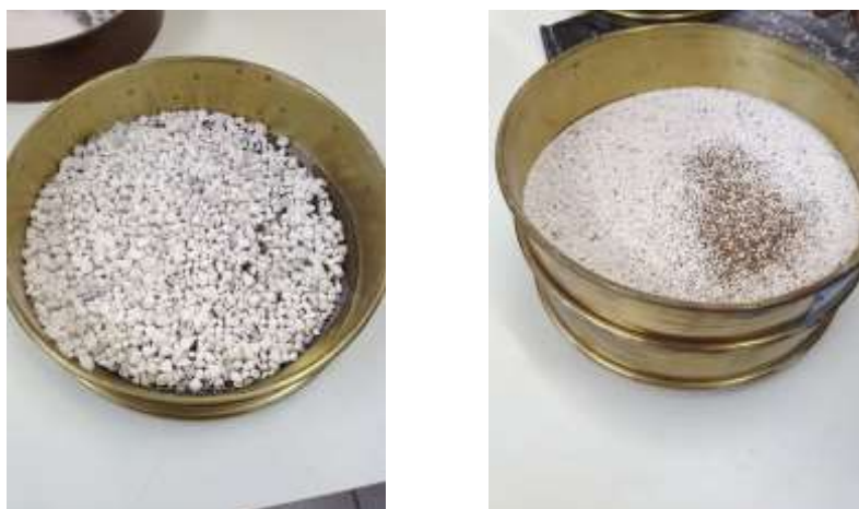
FIGURA 2: Óxido de Magnésio retido nas peneiras de malha igual a 4mm e 0,250mm, respectivamente
