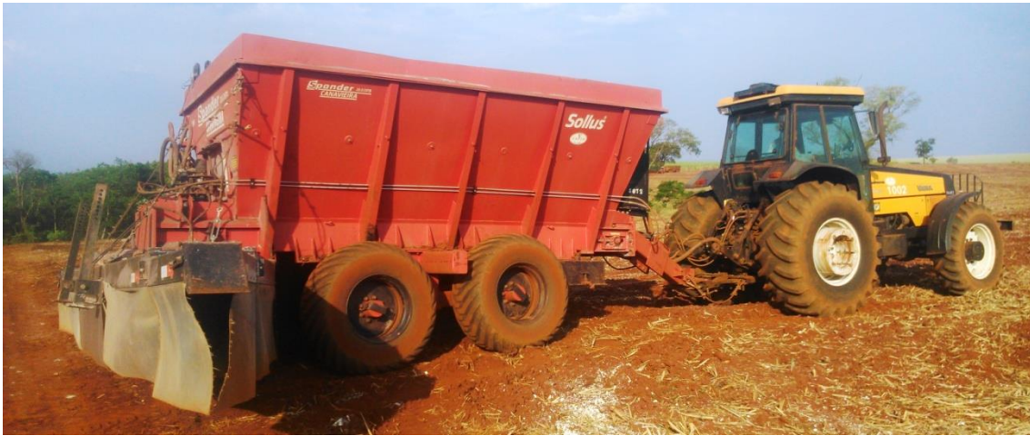
FIGURA 2: Conjunto trator e distribuidor de calcário utilizado no experimento.
