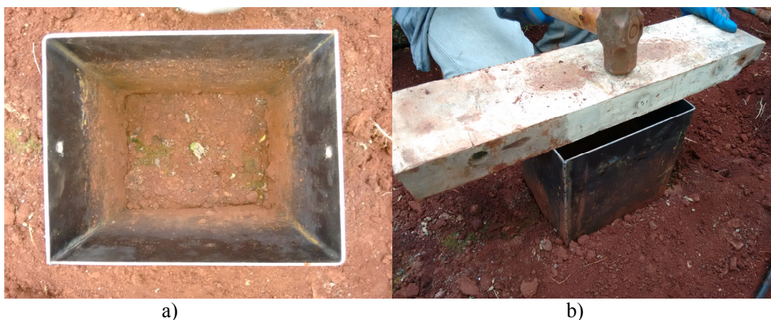
FIGURA 1. a) acomodação do amostrador no canteiro colocando o colo da planta ao centro e tendo a largura de 20 cm de largura com 25 de comprimento. b) com auxílio de uma viga e marreta era introduzido ao solo até a profundidade de 30 cm.
