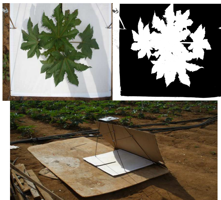
FIGURA 1- Imagem registrada por meio da câmera fotográfica fixada ao estúdio (imagem inferior), a uma distância pré-estabelecida. Ao fundo observa-se o papel milimetrado para fornecimento do fator de escala (imagem superior à esquerda). Foto processada por meio do ImageJ® por diferença de tonalidade (imagem superior à direita)
