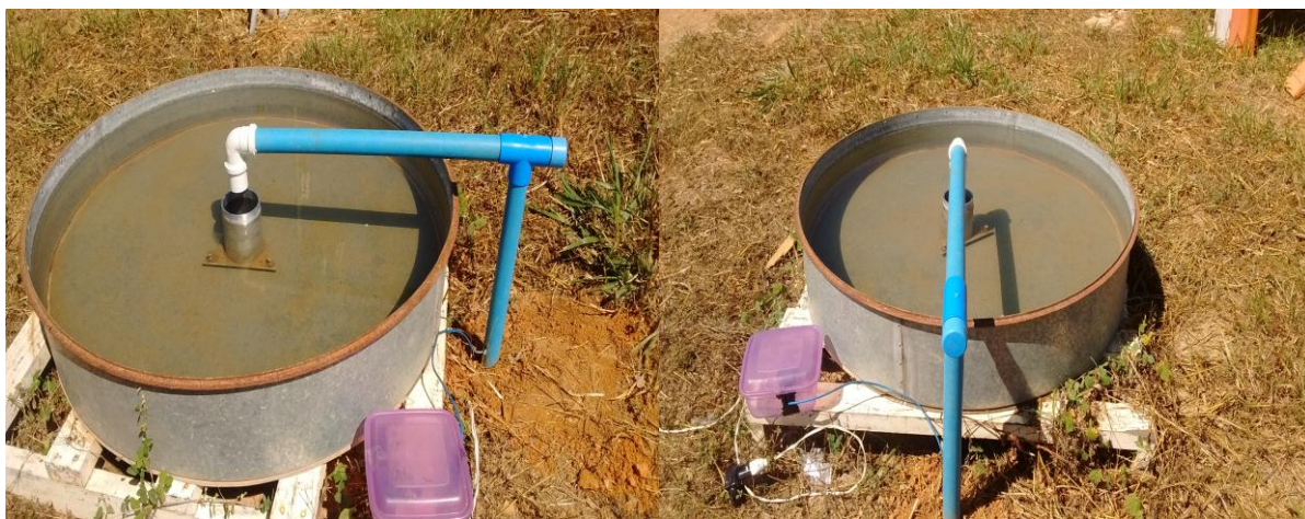
Figura 3. Tanque Classe A com o sistema de coleta de dados instalado
