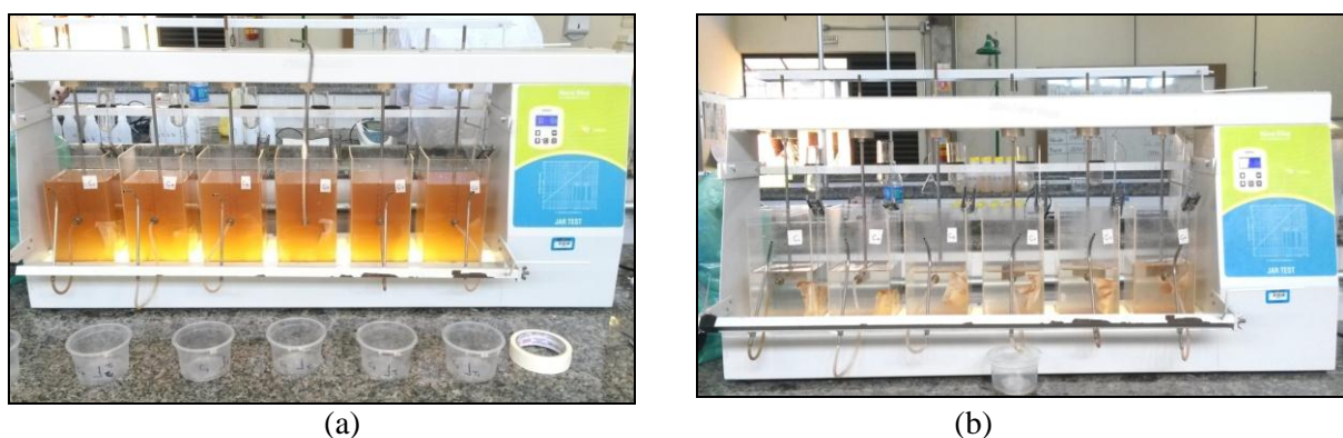
FIGURA 1. Representação do ensaio Jar-test durante o processo de coagulação (a) e durante o processo de sedimentação (b)
