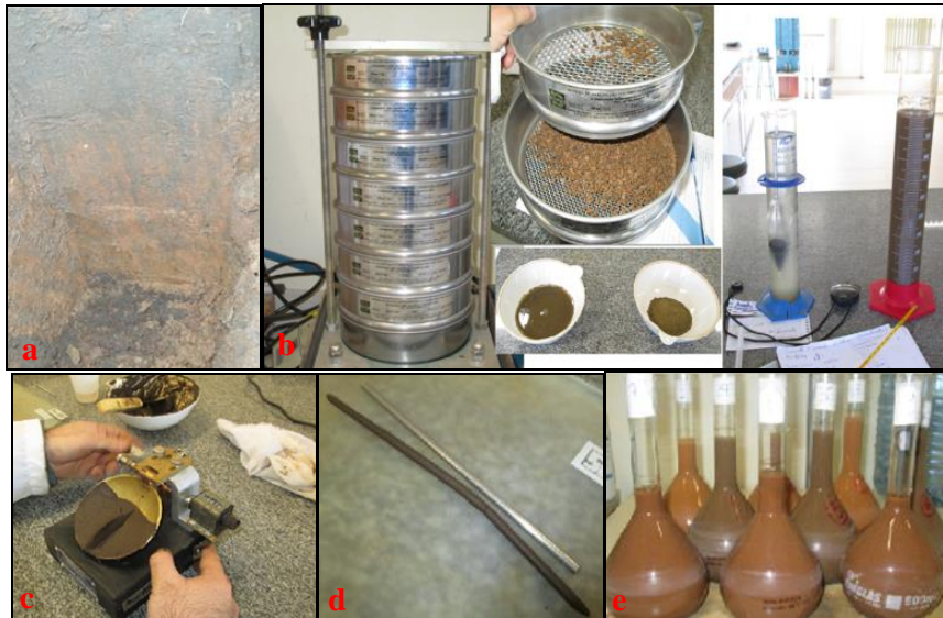
Figura 2. Ensaios de caracterização geotécnica: a) execução de sondagem de poço; b) ensaio de granulometria pelos métodos de peneiramento e sedimentação; c) ensaio de limite de liquidez; d) ensaio de limite de plasticidade; e) ensaio de massa específica dos grãos.
