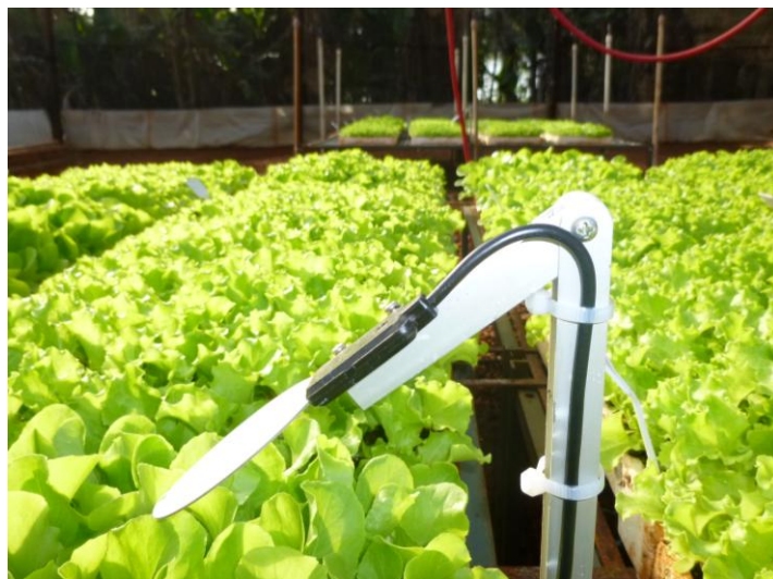
FIGURA 03 Detalhe de instalação do sensor de molhamento foliar, ângulo de 45°
