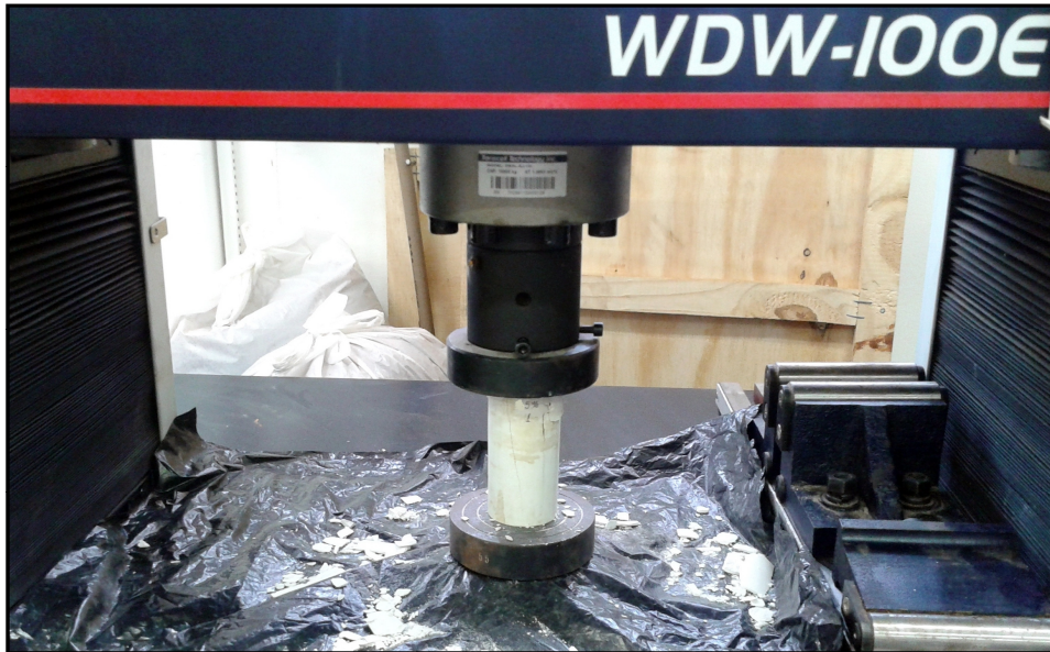
Figura 1. Ensaio de resistência à compressão para compósito com adição de 5% de resíduo de serragem.
